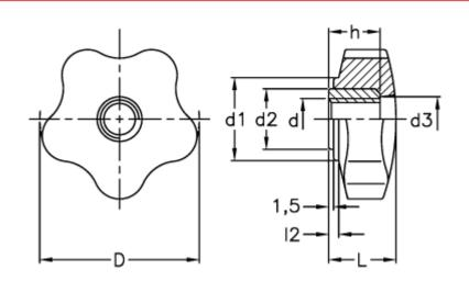
D = 40d1 = 23 d2 = 17 d3 = 14 d6H = M8 h = 15 L = 19 l2 = 3
